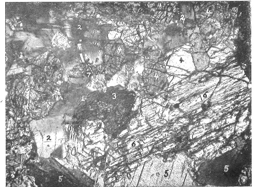
*Muestra núm. 12.* Gabro de hornblenda, augita y biotita, con algo de cuarzo, procedente del kilómetro 40 de la carretera de Badajoz a Jerez de los Caballeros. Luz natural y polarizada, con unos 35 diámetros. 1, cuarzo; 2, plagioclasa, labrador; 3, hornblenda; 4, augita; 5, biotita; 6, dialaga; 7, magnetita.
